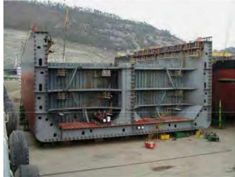
Barcos con doble casco (2.6 m) y doble fondo (2.5 m) dividido en tanques, 12 para un barco 150.000 TRB
