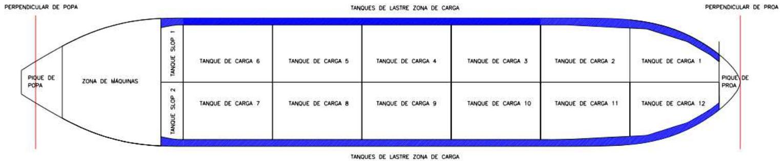
Disposición de tanques y ubicación del agua de lastre (azul)
